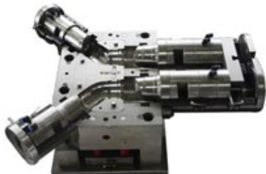
Extrusion-soufflage de conduits à formes complexes en polyalphaléfines, pour l'aéronautique
