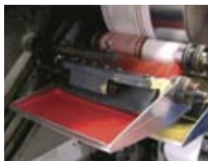
Nettoyage des encres en flexographie
